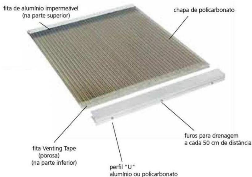
A fixação das chapas deve ser realizada através de perfis de alumínio com gaxeta de neoprene ou EPDM, as quais irão prender sem danificá-las. O esquema de fixação pode ser observado na Figura a seguir.
